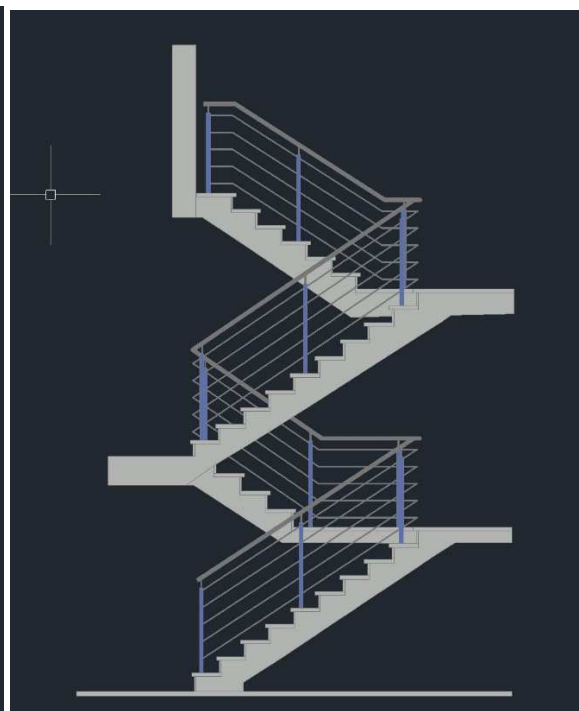
Abbildung 6: neues Geländer in Bestand 2/2
